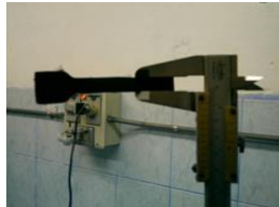
Fotografía 2. Medidas de la probeta (ancho) con el Pie de rey.
