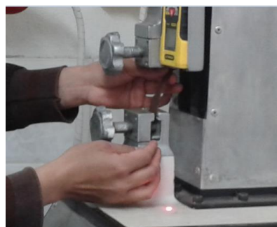
Fotografía 3. Probeta entre las mordazas tensoras.
