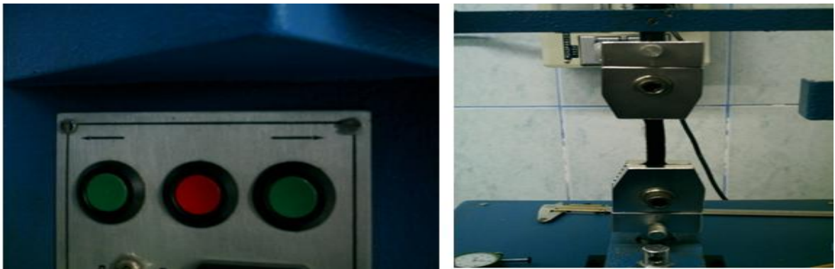
Fotografía 6. Puesta en marcha del prototipo mecánico para medir la resistencia a la tensión del cuero.
