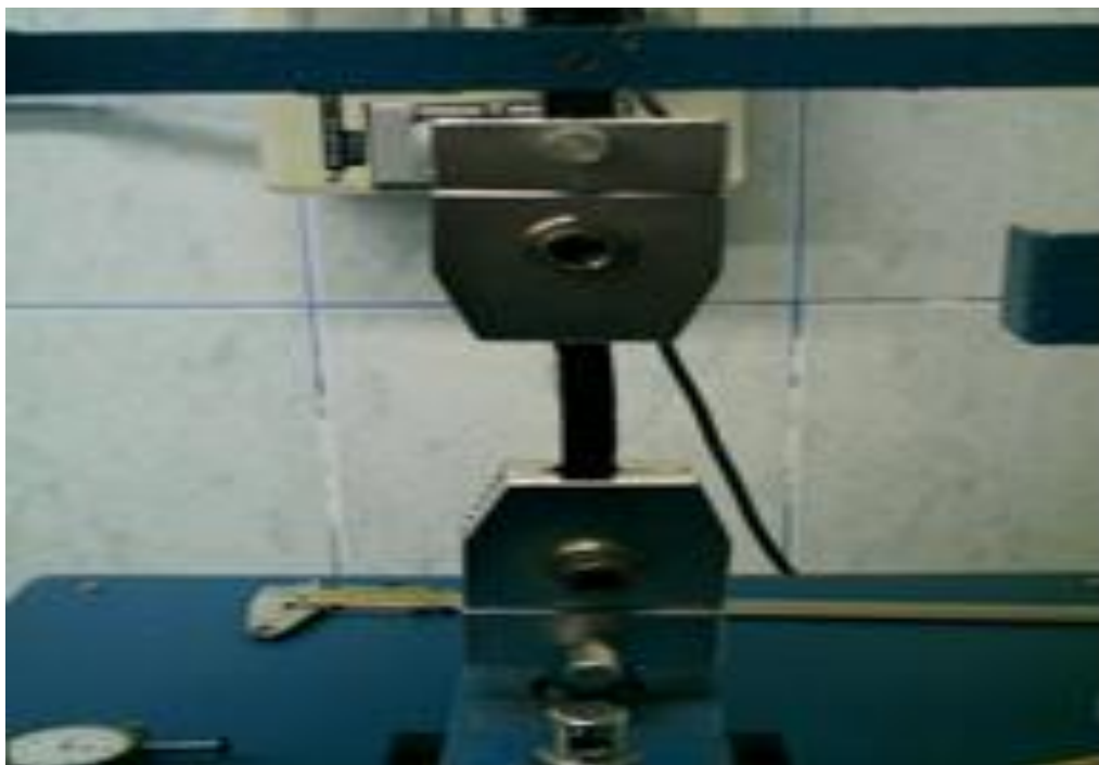
Fotografía 4. Colocación de la probeta de cuero entre las mordazas tensoras.
