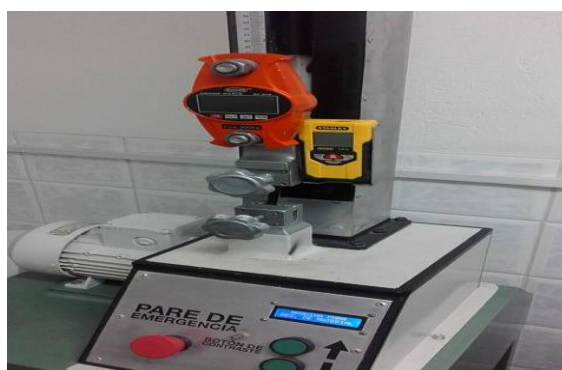
Fotografía 1. Partes de un equipo para realizar la medición de la resistencia a la tensión el cuero.
