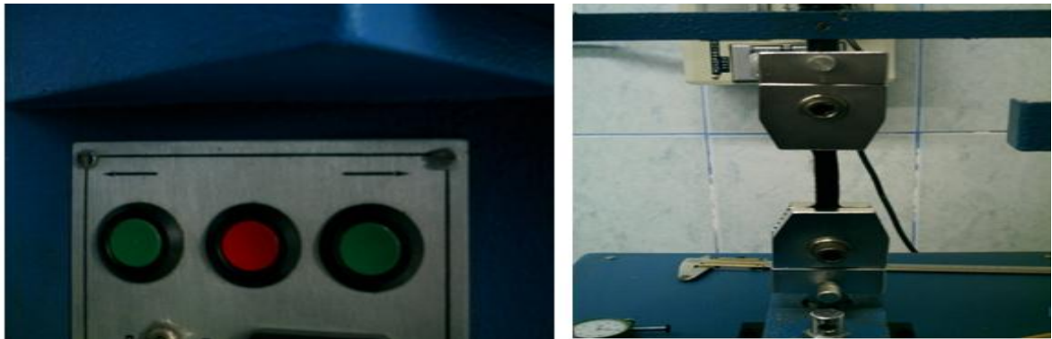
Fotografía 8. Puesta en marcha del prototipo mecánico para medir la resistencia a la tensión del cuero.
