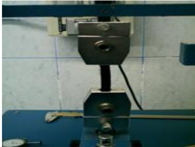
Fotografía 6. Colocación de la probeta de cuero entre las mordazas tensoras.
