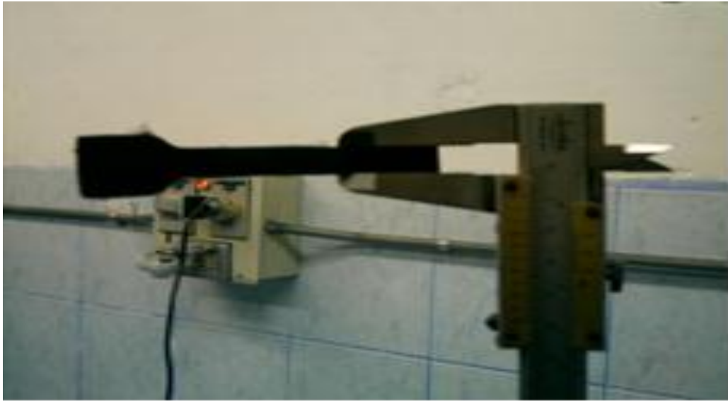
Fotografía 4. Medición con un pie de rey del ancho del cuero.
