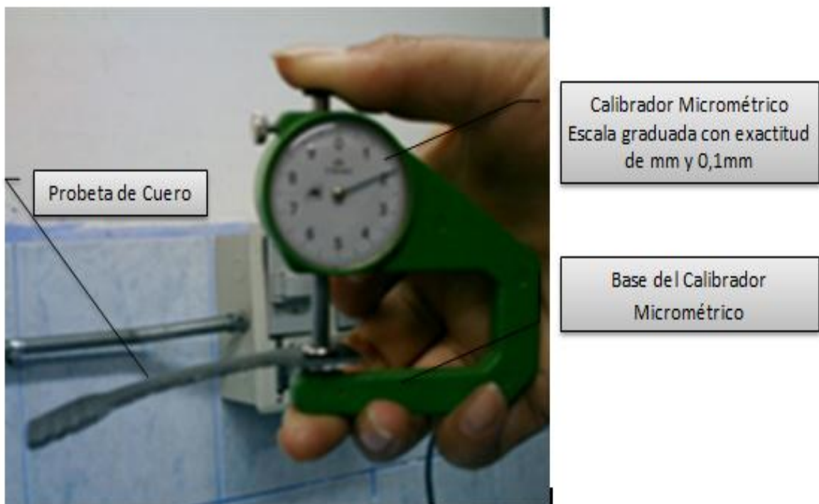
Fotografía 3. Equipo para medir el espesor del cuero.
