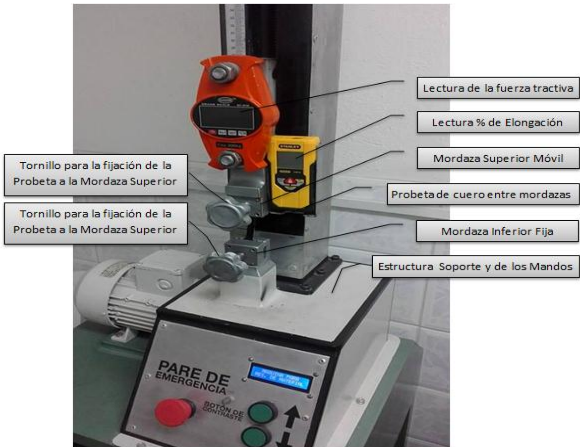
Fotografía 2. Máquina para el test de resistencia a la tensión.
