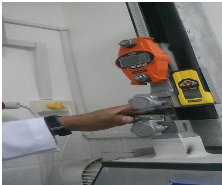
Gráfico 6. Equipo para realizar la medición de la resistencia a la tensión.
