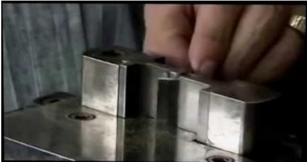
Gráfico 5. Troquel para realizar el corte de la probeta para el análisis de la resistencia a la tensión.
