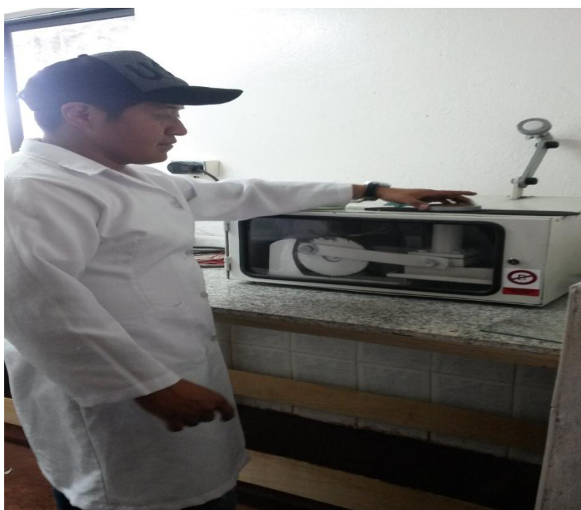
Gráfico 12. Equipo para la medición de la resistencia al frote en seco del cuero.
