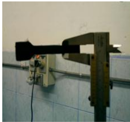
Gráfico 8. Medición de la longitud inicial del cuero.
