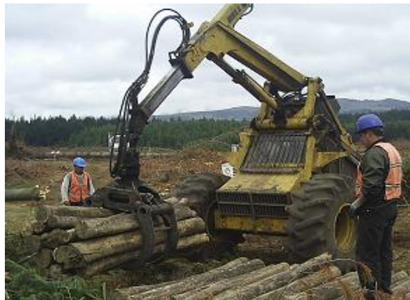
Foto N°9. Carga de trozas con Bell
