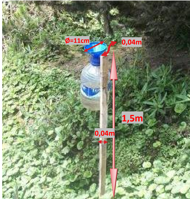
Foto 1. Modelo Pluviómetro Casero.
