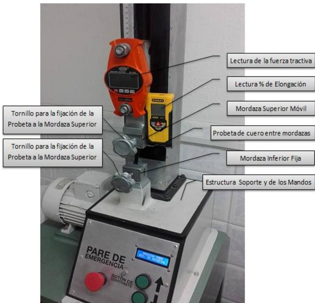
Figura 2. Máquina para el test de resistencia a la tensión.
