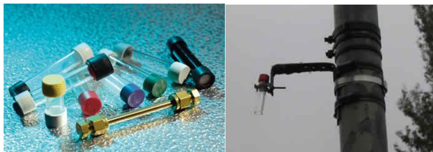
Figura 2-1: Tubos de difusión para detección de nitrógeno y benceno.
