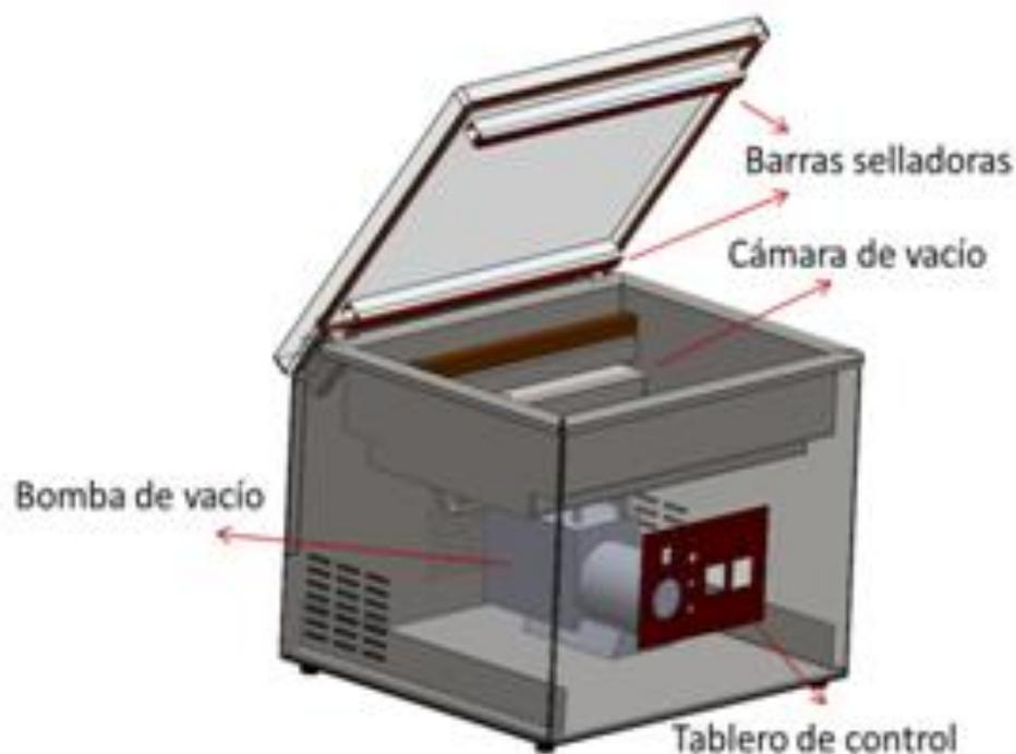
Gráfico 3. Partes de una empacadora al vacío.
