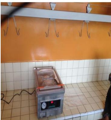
Paso 9.- Una vez culminado el tiempo de empacado y sellado, automáticamente se abre la tapa de la máquina.
