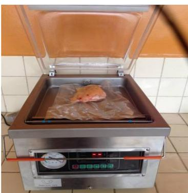
Paso 8.- Colocar el seguro que asegura la tapa de la máquina.
