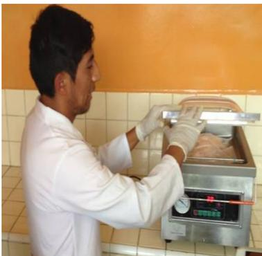
Paso 7.- Presionar hacia abajo la tapa de la máquina, e inmediatamente la bomba de vaciado empieza a aspirar aire.
