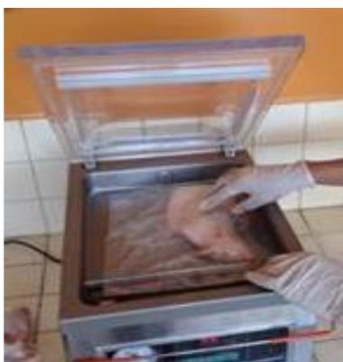
Paso 6.- Colocar la bolsa dentro de cámara de vacío con dirección hacia la banda de sellado.
