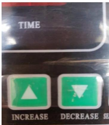
Paso 3.-Regular el tiempo de sellado (1,5 a 4,5 s) accionando "SEALING" que se encuentra en el tablero digital.
