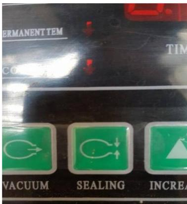
Paso 2.- Regular el tiempo de vacío, (10 a 30 s.) accionando "VACUUM" que se encuentra en el tablero digital.
