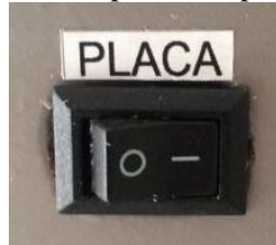
Figura 12-4. Interruptor de la placa de control
