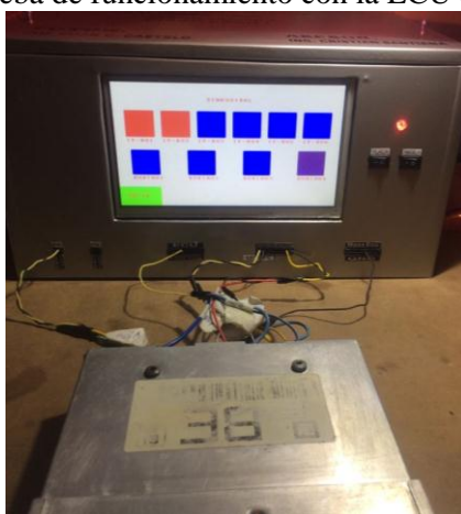
Figura 18-4. Prueba de funcionamiento con la ECU del Corsa B 1.6 cc
