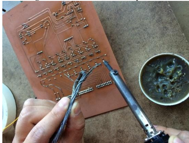
Figura 15-3. Soldadura de componentes
