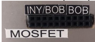
Figura 11-4. Conector de inyector y bobinas
