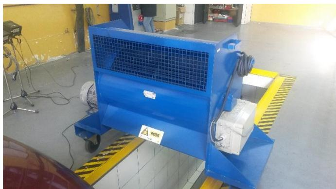
**FIGURA 3-5.** Ventilador de flujo laminar
