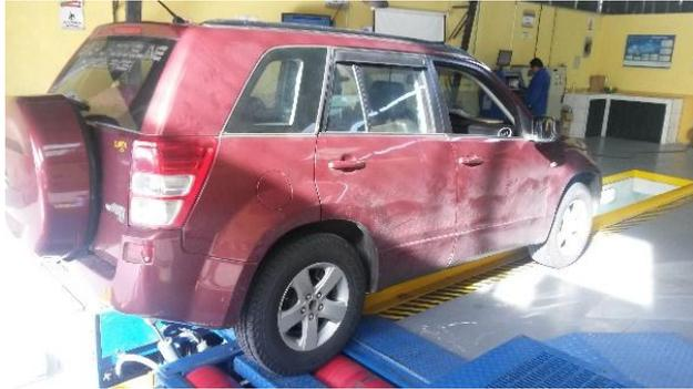
**FIGURA 3-3.** Montaje del vehículo en el banco dinamométrico
