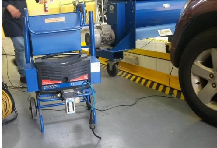
**FIGURA 3-12.** Analizador de gases a gasolina utilizado en la prueba
