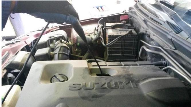
**FIGURA 3-6.** Instalación de la sonda de temperatura de aceite
