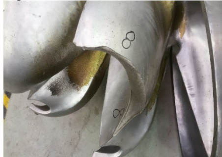
Figura 41. Rodete Pelton fracturado
