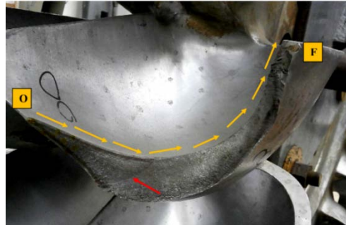
Figura 43. Esquematación de la dirección de agrietamiento sobre el rodete Pelton fracturado
