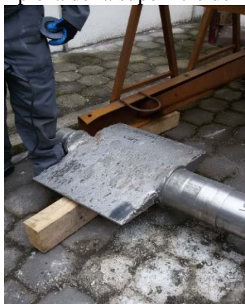
Figura 36. Limpieza de la superficie del álabe directriz
