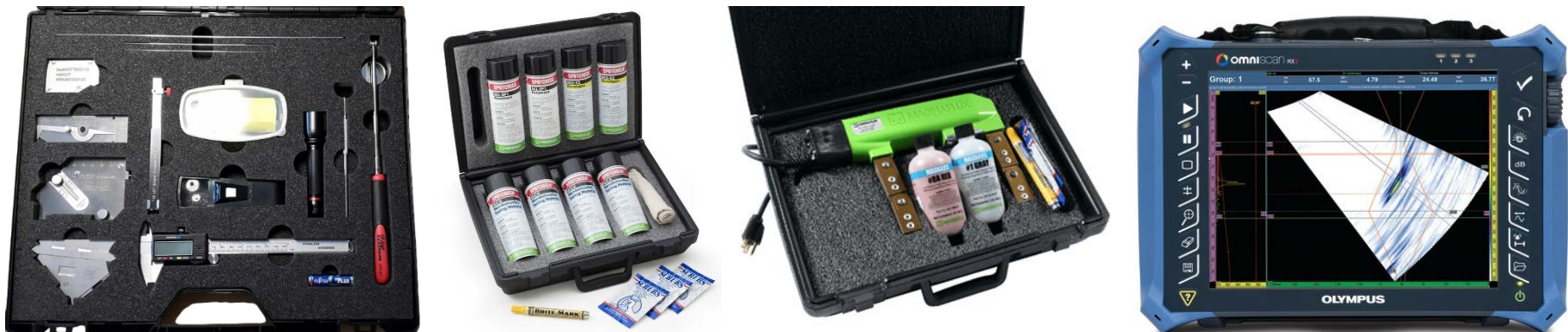
Figura 32. Equipos de END de VT, PT, MT, UT en ese orden correspondiente a las imágenes
