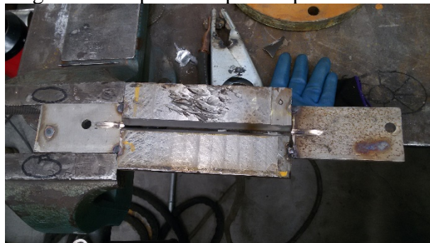
Figura 86. Cupones de prueba para soldadura
