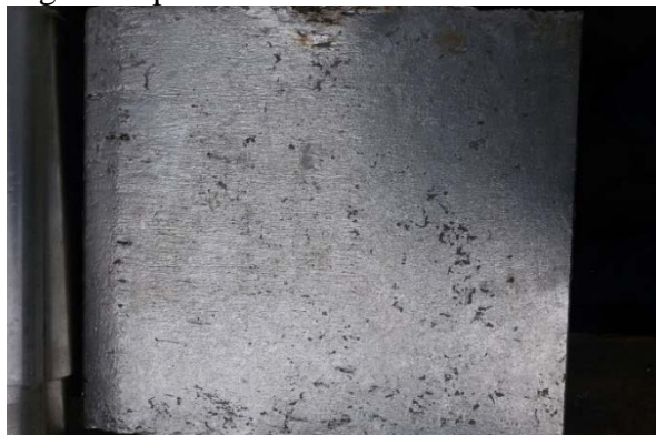
Figura 39. Desgaste superficial en el lado de succión del álabe directriz
