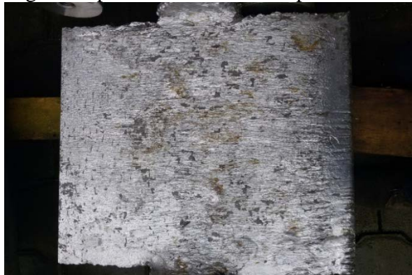
Figura 38. Desgaste superficial en el lado de presión del álabe directriz
