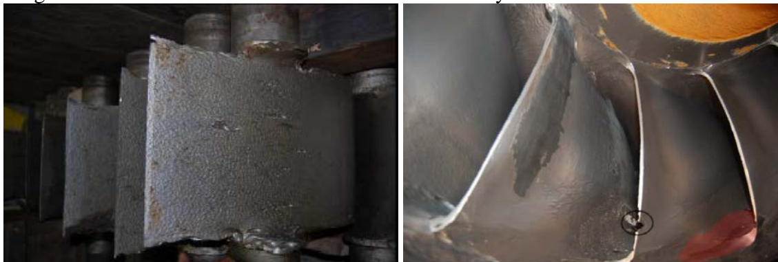
Figura 20. Efectos de la erosión en los álabes móviles y rodete de una turbina Francis
