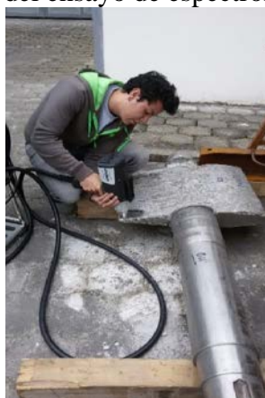
Figura 37. Realización del ensayo de espectrometría en álabe directriz
