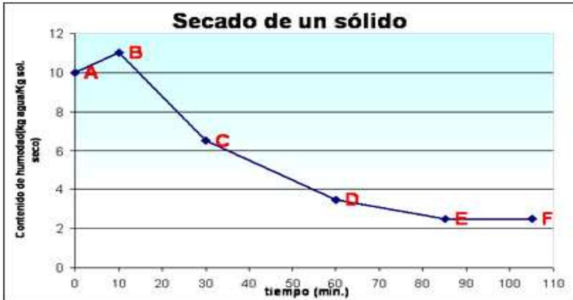
FIGURA No. 8. PERFIL DE SECADO DE UN SOLIDO
