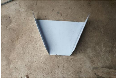
Figura.12-5: Montaje de la tolva de dosificación.
