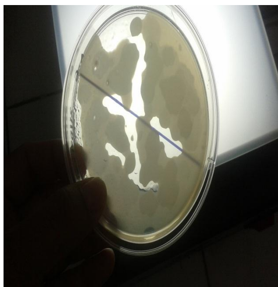
Fotografía N° 40: Resultados de la prueba hidrolisis de gelatina Realizado por: BENAVIDES Cyntia ,2017
