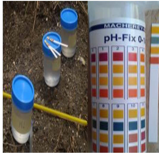
Fotografía N° 9: Medición pH. Realizado por: BENAVIDES Cyntia ,2017
