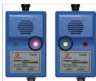
El foco rojo como se muestra en la figura se encenderá lo que quiere decir que la batería está siendo cargada y se mantendrá así hasta que este cargada en su totalidad y se encienda el foco verde, en ese momento se puede desconectar todo y volver a colocar la batería en el robot.
