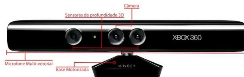
**Figura 7-1:** Arquitectura del Sensor Kinect.
