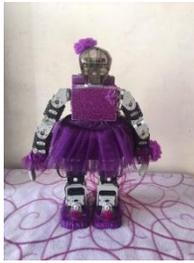
Colocar el robot en un área lisa, verificar que el robot este en una posición firme y que los cables de conexión de cada extremidad tengan libertad para moverse sin ningún problema, es decir que no estén enredados o enganchados.
