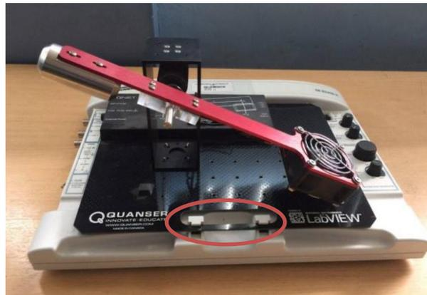
**Figura 1-2 Conexión de la planta QNET VTOL al ELVIS II**
