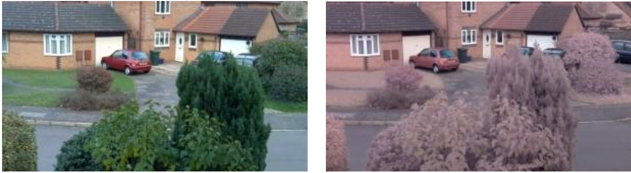
FIGURA 7-1: COMPARACIÓN ENTRE UNA CAPTURA CONVENCIONAL CON CAPTURA MEDIANTE PI NOIR. Fuente: http://raspi.tv/2013/pinoir-whats-it-for-comparison-of-raspicam-and-pi-noir-output-in-daylight
