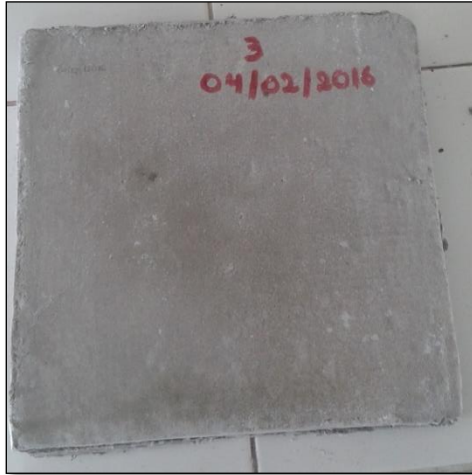
Fotografía 21. Probeta de fibrocemento
