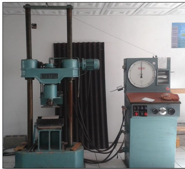
Fotografía 18. Equipo para medición de módulo de rotura (Prensa Hidráulica Universal)
