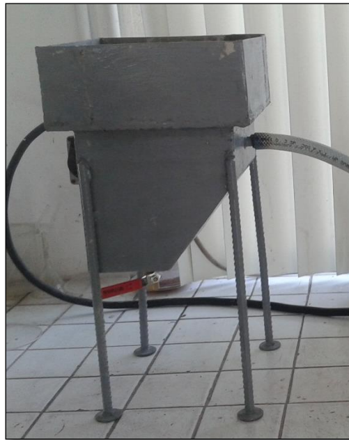
Fotografía 23. Útil para simulación de filtración al vacío
