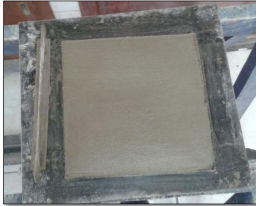
Fotografía 19. Moldeo de la probeta
