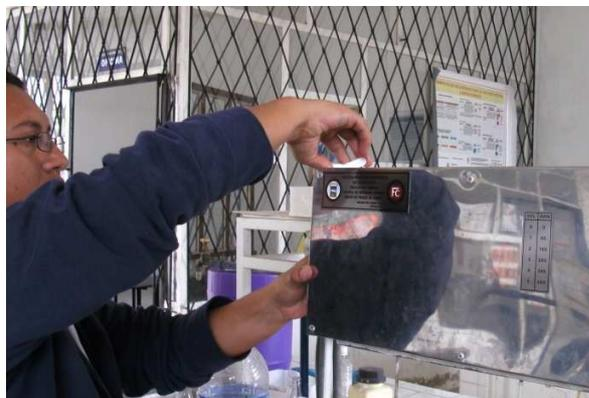
Se extrae un determinado volumen de cada jarra para poder analizarlo en el turbidímetro.
