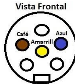
Figura 3-3. Disposición de pines sensor LVDT
