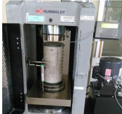
Figura 2-4. Cámara de ensayos con el sensor LVDT
