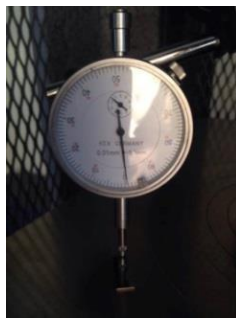
Figura 9-4. Toma de datos con el medidor analógico
