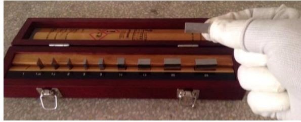
Figura 4-4. Placas normalizadas de 1mm hasta 25mm
