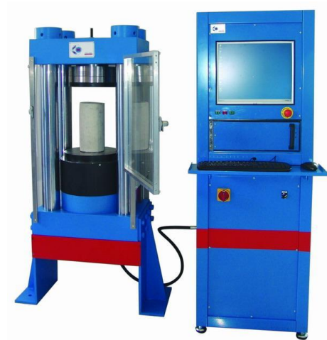
Figura 26-3. Modelo común de equipo de ensayo de materiales
