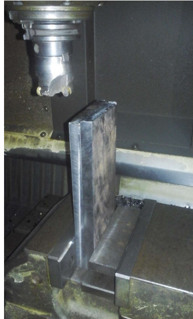
Figura 102. Mecanizado de bordes de las placas de expulsión.
