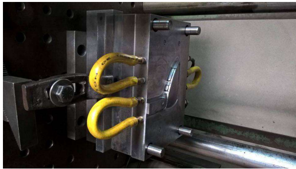
Figura 111. Sujeción del conjunto móvil a la placa de la inyectora.
