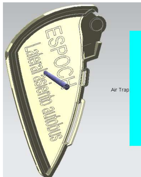
Figura 87. Análisis de aire atrapado
