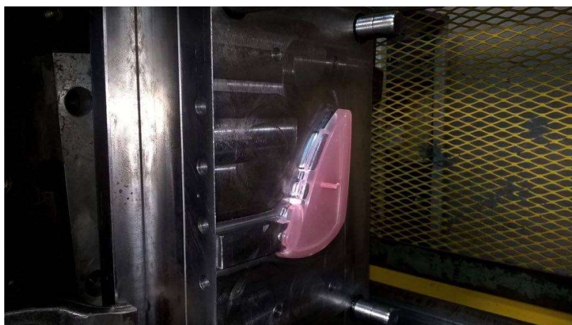
Figura 118. Conformado del polipropileno dentro de las cavidades
