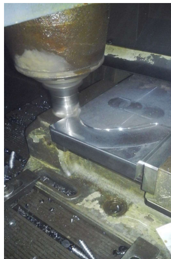
Figura 97. Planeado de las superficies de la cavidad.
