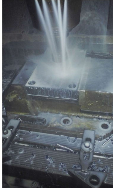
Figura 104. Mecanizado de las perforaciones para el guiado
