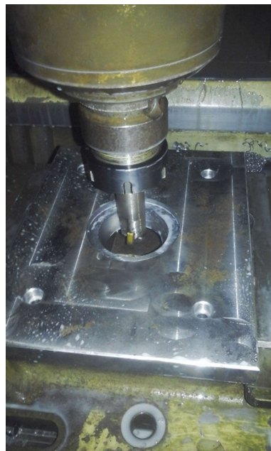
Figura 105. Mecanizado de perforaciones que alojan al bebedero.
