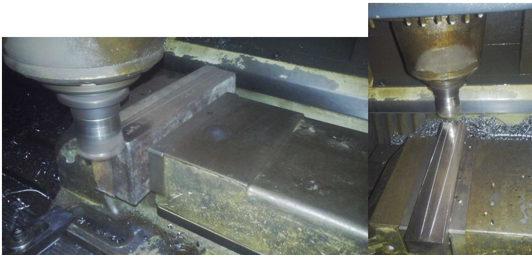
Figura 101. Mecanizado de los bordes y planeado de las placas paralelas.
