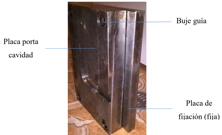
Figura 107. Ensamble de la parte fija del molde.
