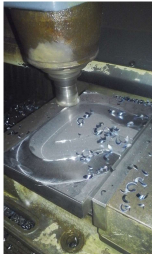
Figura 99. Planeado de placa móvil
