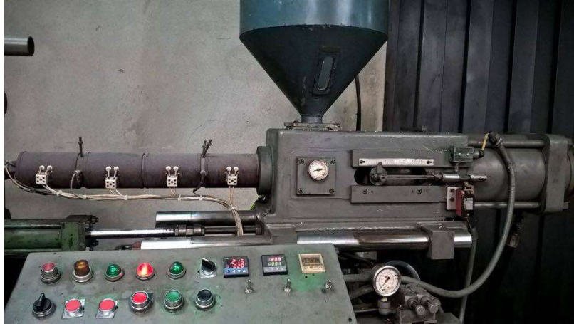
Figura 116. Ingreso de parámetros de inyección en la máquina
