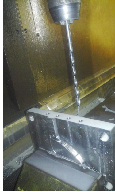
Figura 106. Perforaciones del sistema de refrigeración
