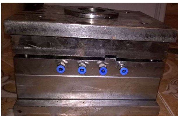
Figura 109. Montaje total de la matriz
