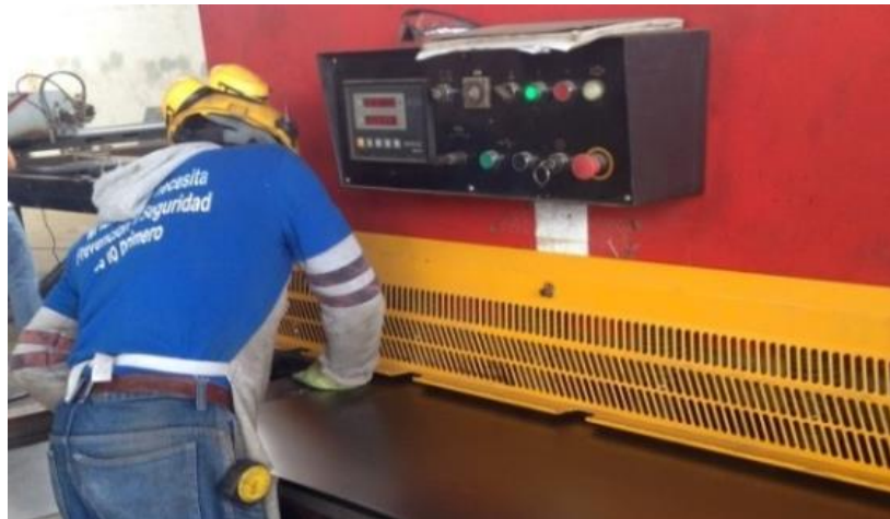
Figura 83. Corte de la chapa metálica mediante cizalla hidráulica
