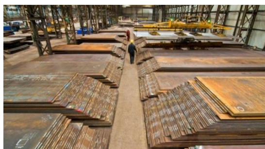
Figura 13. Planchas de acero al carbono sin recubrimiento
