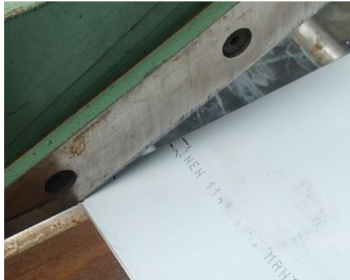
Figura 85. Corte de la chapa metálica mediante cizalla manual
