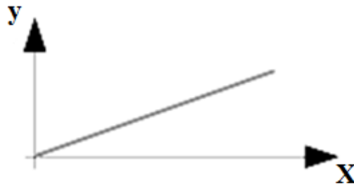
Figura 74. Oscilación de la señal para un control integral
