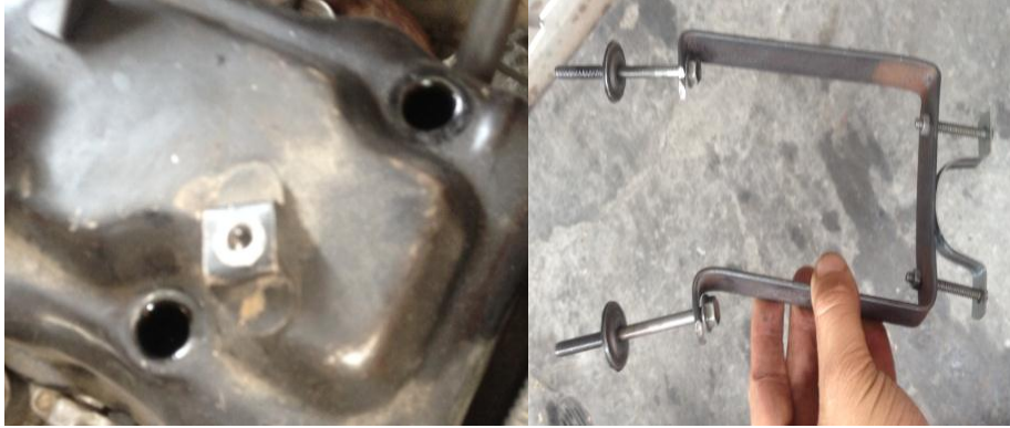
Figura 24-5. Desmontaje de los pernos del tapa válvulas y soporte de fijación del reactor Fuente: propia
