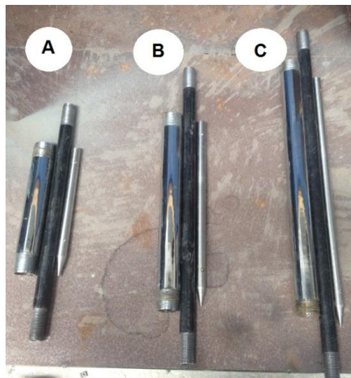
Figura 16-5. Construcción de los elementos para el reactor A, B y C.
