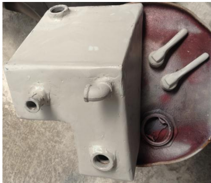
Figura 17-5. Burbujeador de 5300 cm 3 de capacidad.
