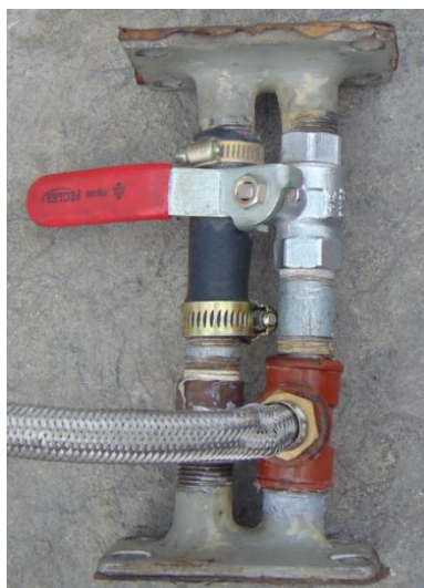
Figura 20-5. Vista general del acople de admisión
