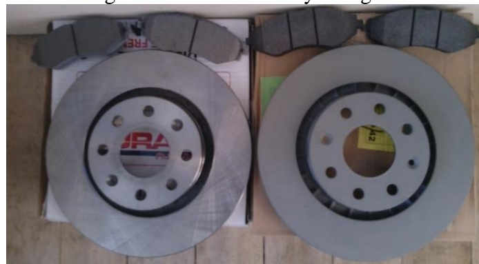
Figura 39. Probetas ensayo desgaste
