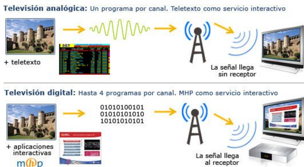
Figura 2-1 Diferencia televisión analógica y digital
