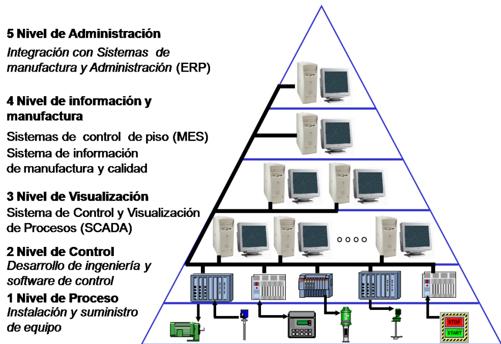
Figura 1-2: Pirámide de la Automatización
