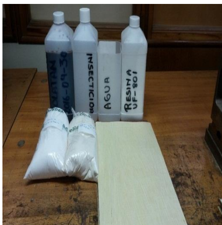
Fotografía 6-1: Componentes para la elaboración de la mezcla encolante.
