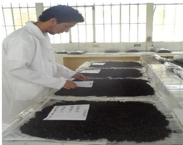
**Figura 15:** Secado de muestras de suelo.
