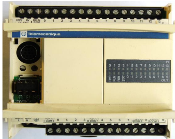
Figura 6 - 1 PLC Twido TWDLCAA24DRF Realizado por: MOYOTA ,B; GUILCAPI , L, 2017
