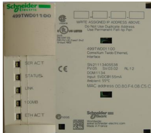
Figura 8 - 1 Módulo TWIDOPORT 499 TWD 01100 Realizado por: MOYOTA, Byron; GUILCAPI, Lidia, 2017
