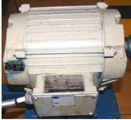
Figura 15 - 1 Motor Trifásico (C.A) de 5HP Realizado por: MOYOTA, Byron; GUILCAPI, Lidia, 2017
