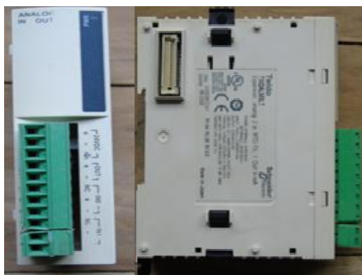
Figura 9 - 1 Módulo de E/S Analógicas TWDALM3LT Realizado por: MOYOTA, Byron; GUILCAPI, Lidia, 2017
