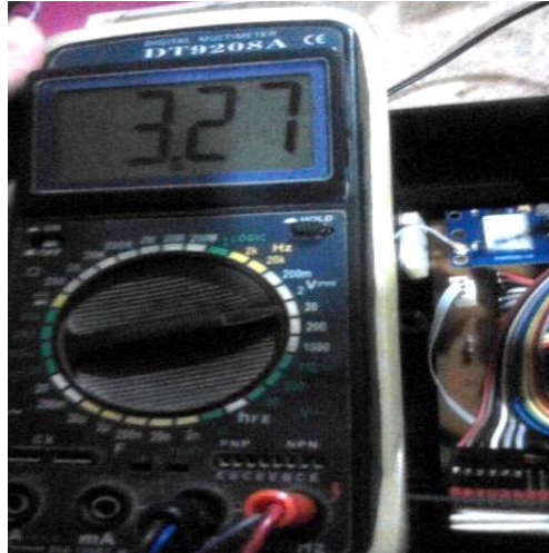
Figura 3-3 Alimentación de la Shield GPS. Fuente: FREIRE, Edisson; CHALÁN Richard, 2017
