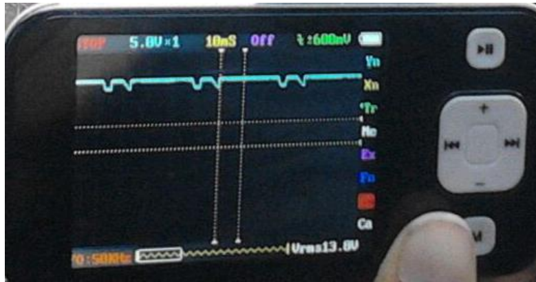
Figura 17-2 Señal simulada de los inyectores Fuente: FREIRE, Edisson; CHALÁN Richard, 2017
