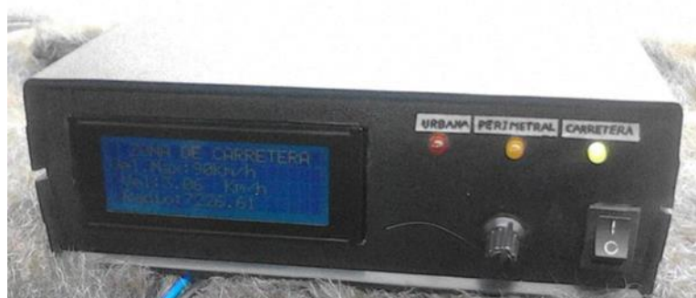
Figura 5-3 Sistema implementado indicando la zona Fuente: FREIRE, Edisson; CHALÁN Richard, 2017
