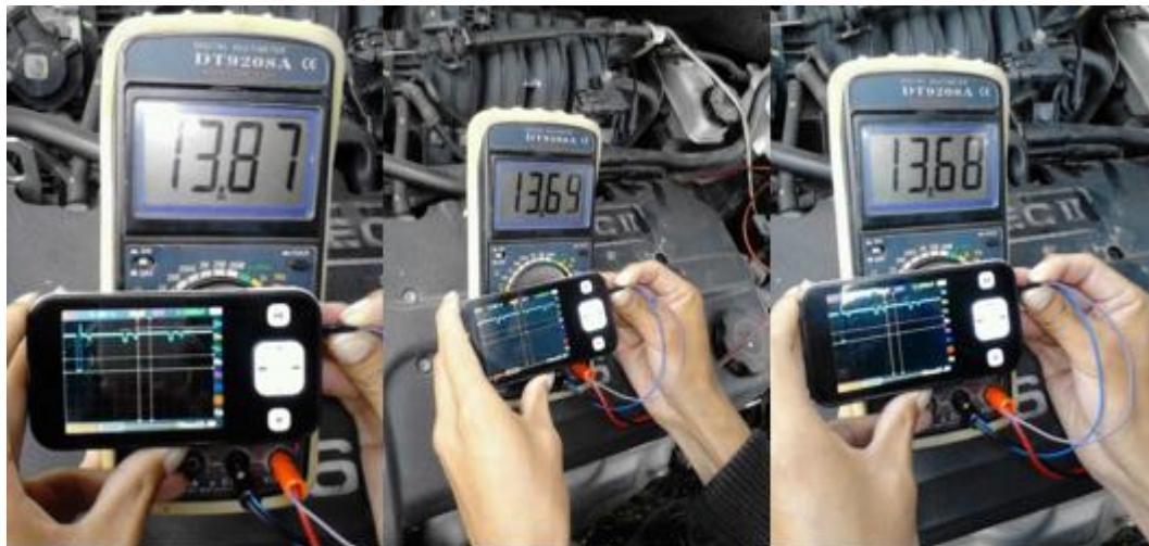
Figura 4-3 Variación de voltajes en la señal de inyección. Fuente: FREIRE, Edisson; CHALÁN Richard, 2017
