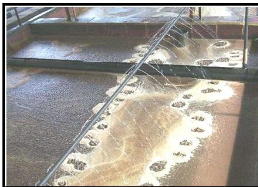
Figura 9 – 1: Tanque florentino, utilizado en las extractoras para recuperación de aceite
