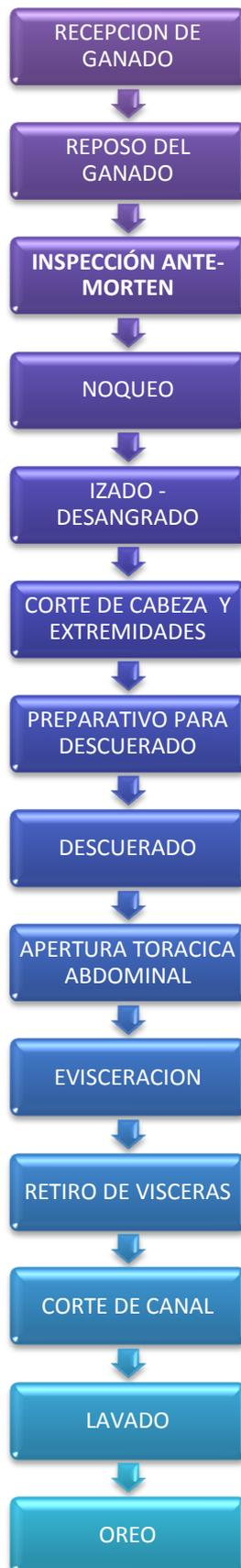
**Figura 6-3.** Diagrama de bloques del proceso de faenamiento de bovinos CMR
