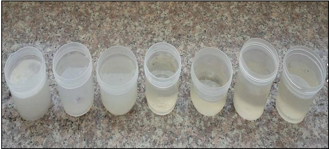
Figura 25-2: Avance del proceso de tratamiento del agua residual
