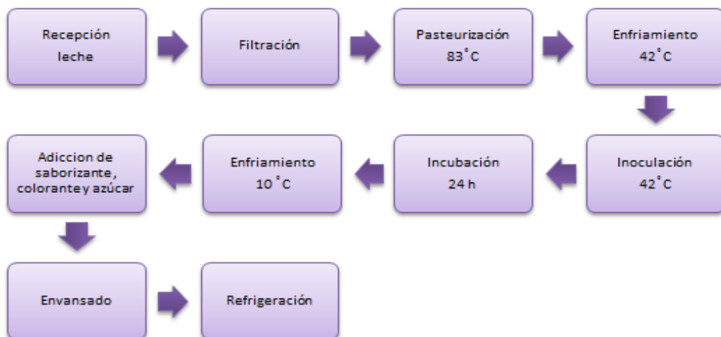
Figura 3-1 : Diagrama de flujo del proceso de elaboración del yogurt
