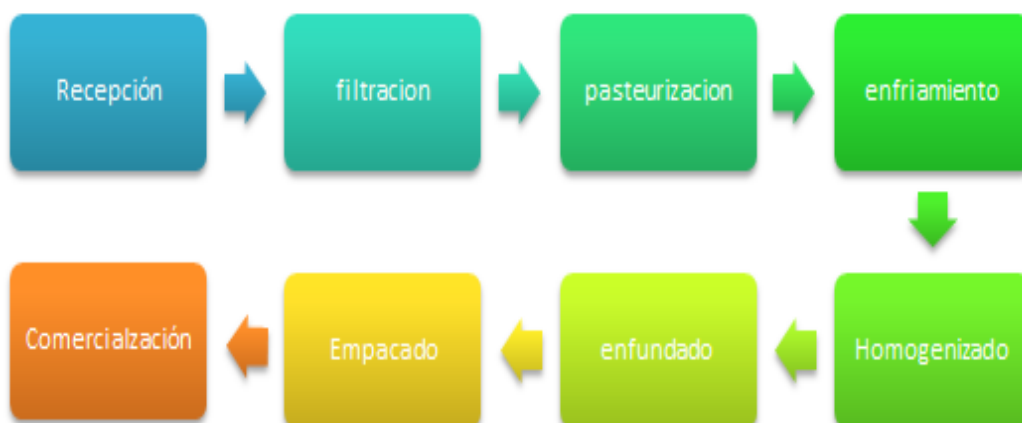
Figura 2-1 : Diagrama de flujo del proceso de elaboración de leche pasteurizada
