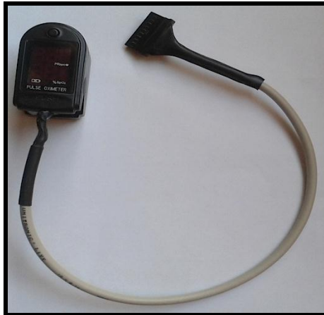
Figura 10-2. Sensor de Pulso y oxígeno en la sangre (SpO2) Realizado por: Loachamin, Mercy; Ribadeneira, Verónica, 2016
