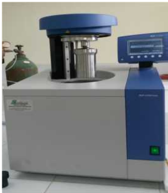
Figura. 3-2: Bomba Calorimétrica(IKA 2000) Realizado por: Angélica Chugñay, 2016.
