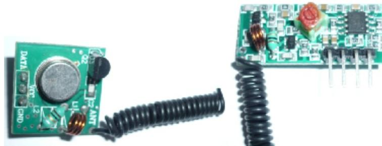
Figura II-9. Módulo RF a 434 MHz
