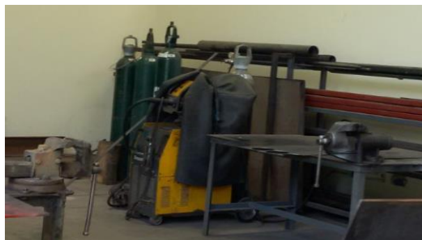
Figura 11. Almacenaje inseguro de cilindro de gases.
