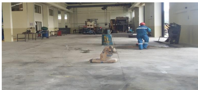
Figura 74. No existencia de señalética de seguridad horizontal. Fuente: Autor
