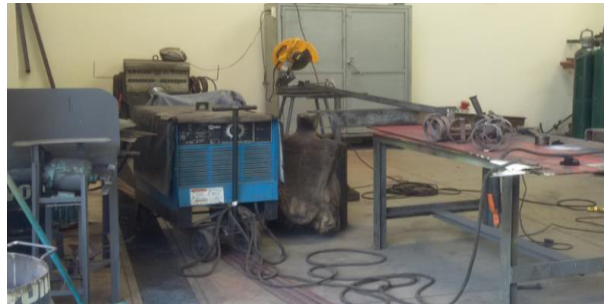
Figura 4. Espacio insuficiente entre máquinas. Fuente: Autor
