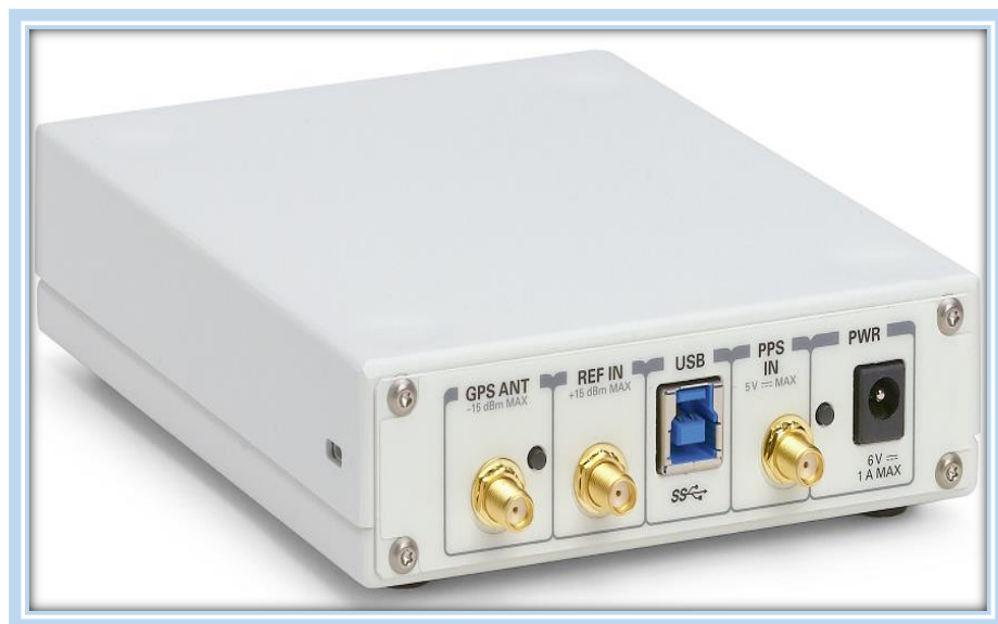
Figura 3-2: Vista posterior de la USRP B210
