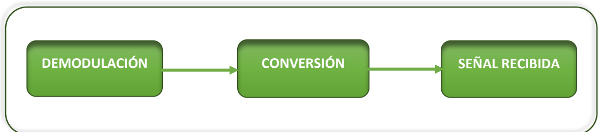
Figura 11-2: Bloques que conforman la recepción de la señal Realizado: MERCHÁN, C, 2016
