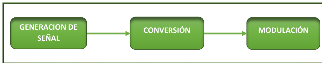
Figura 9-2: Bloques que componen la señal chirp
