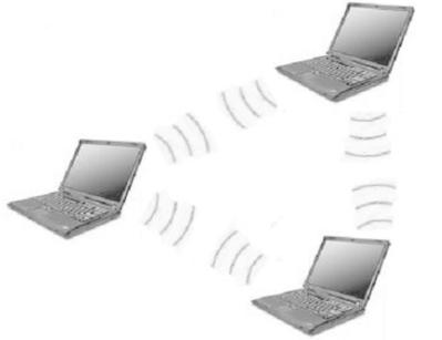
**Figura II.1** Modo de operación de un IBSS
