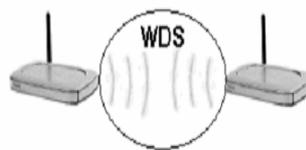
**Figura II.5** Sistema de Distribución Inalámbrico
