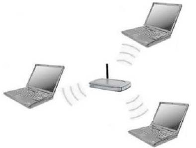
**Figura II.2** Modo de operación de una red de tipo infraestructura
