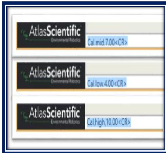
**Figura 9-3** Comandos de calibración para la sonda de pH
