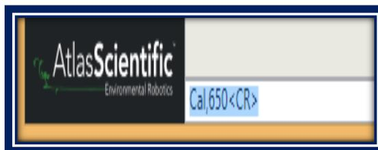
**Figura 10-3** Comandos de calibración para la sonda de ORP
