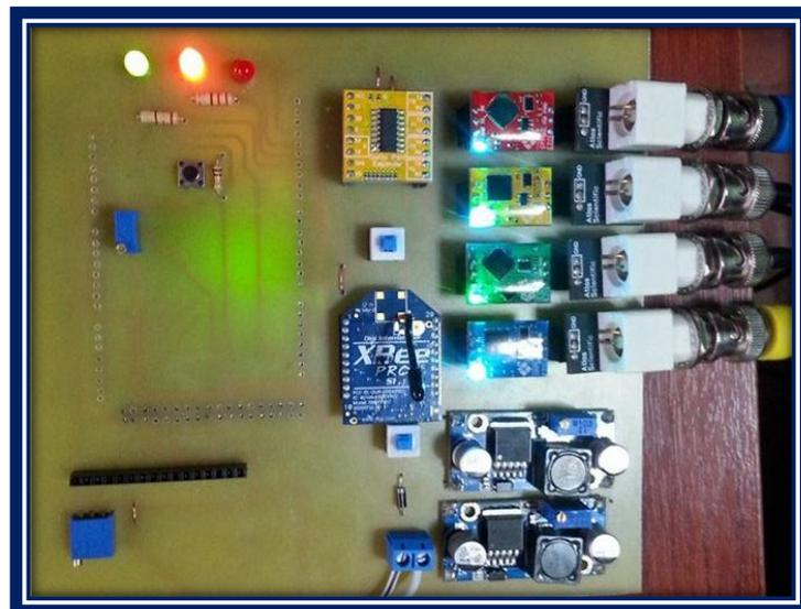
**Figura 17-3** Dispositivo final nodo sensorial
