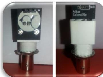
**Figura 3-2** Vista trasera y frontal del conector BNC
