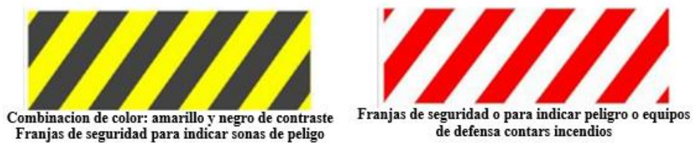
Figura 23-4: Señales adicionales o auxiliares
