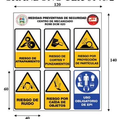
Ilustración 52.- Cartel de medidas preventivas de seguridad en los centros de mecanizado BRIDGEPORT VMC 800/2, ROMI 620 5X y máquina CNC SHANDONG CLK 6140/2
