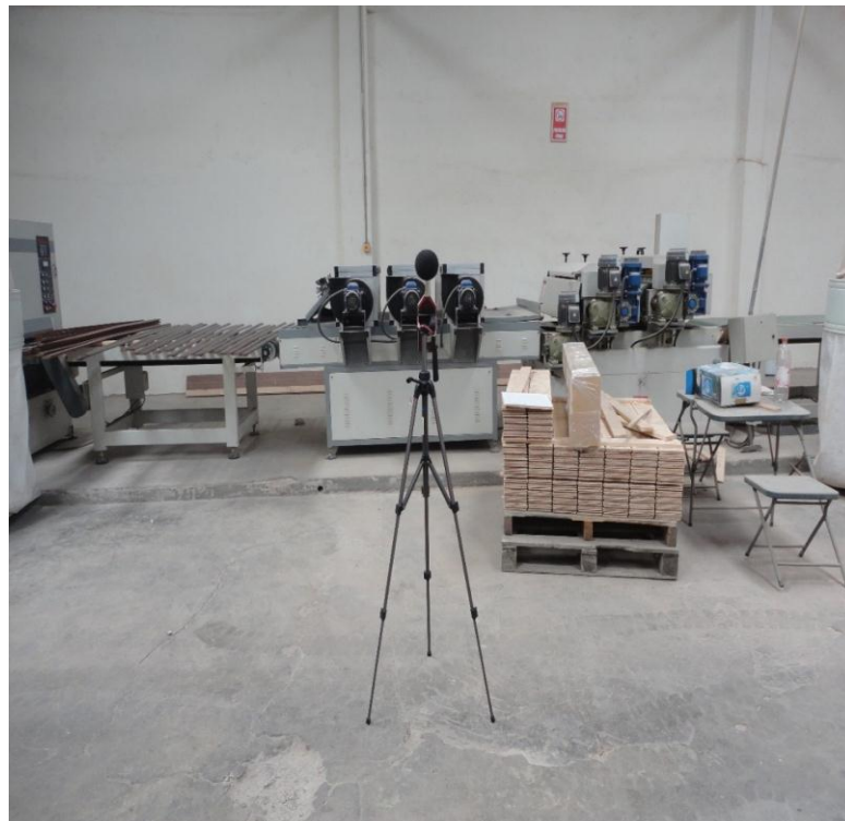
Foto N° 19. Ruido de fondo túnel de lacado
