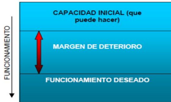
Figura 2-1: Margen de deterioro.
