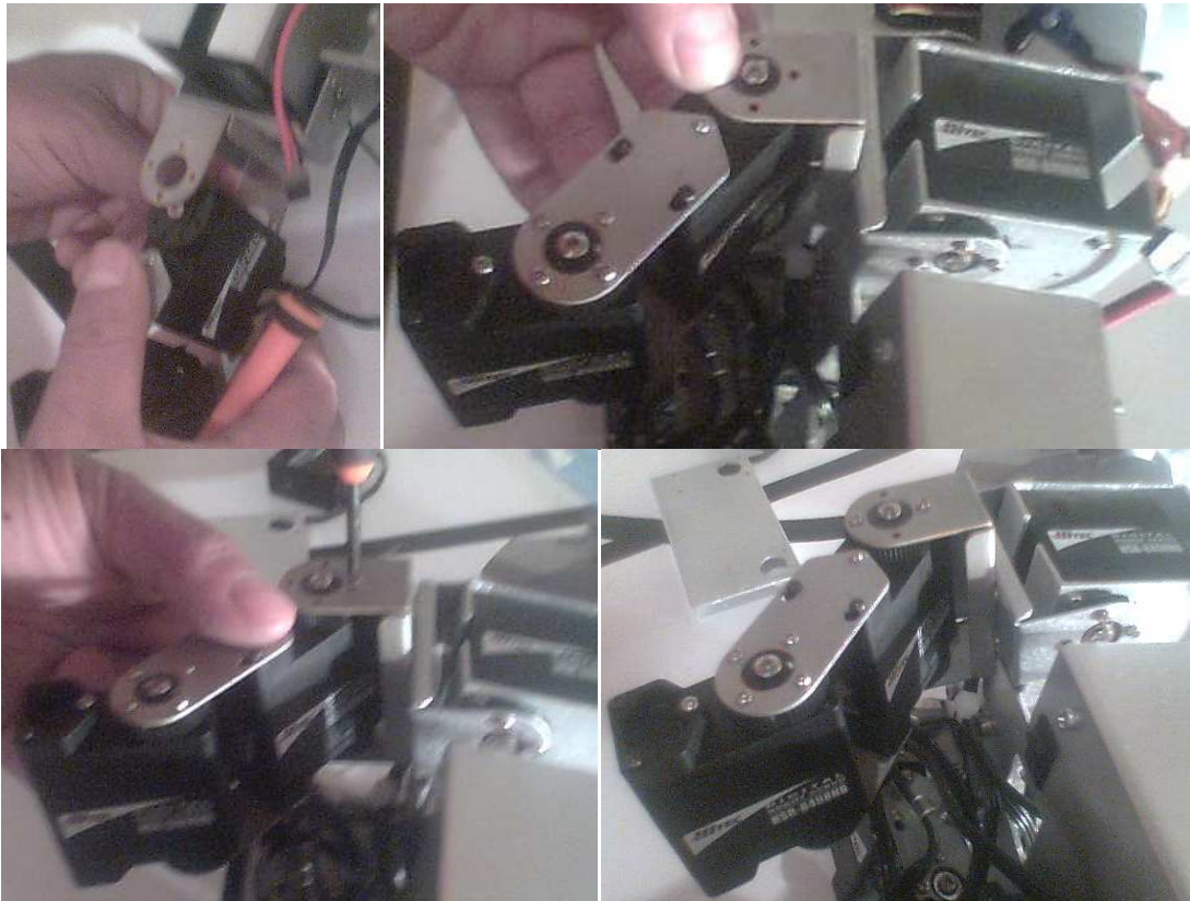
FiguraVI.58. Montaje de las extremidades al cuerpo del robot
