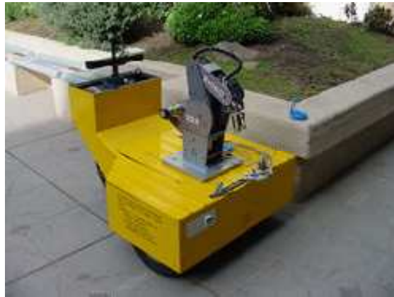
Figura II.10. Sistema Autónomo Robot Móvil + Brazo Robótico desarrollado por el Grupo GIII en Argentina.
