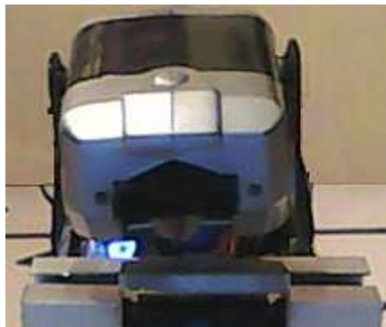
FiguraVIII.87. Sensor Sharp ubicado en la boca del robot
