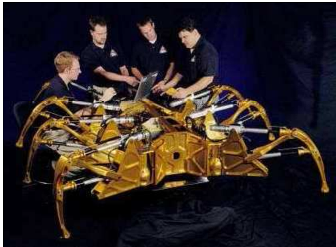
Figura II.7. Robot Spidernaut, de la NASA 5
