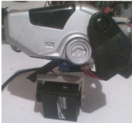
FiguraVI.55. Unión de la cabeza al servomotor del cuello
