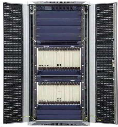
Figura V-42: Vista Frontal del Gabinete de UMG8900
