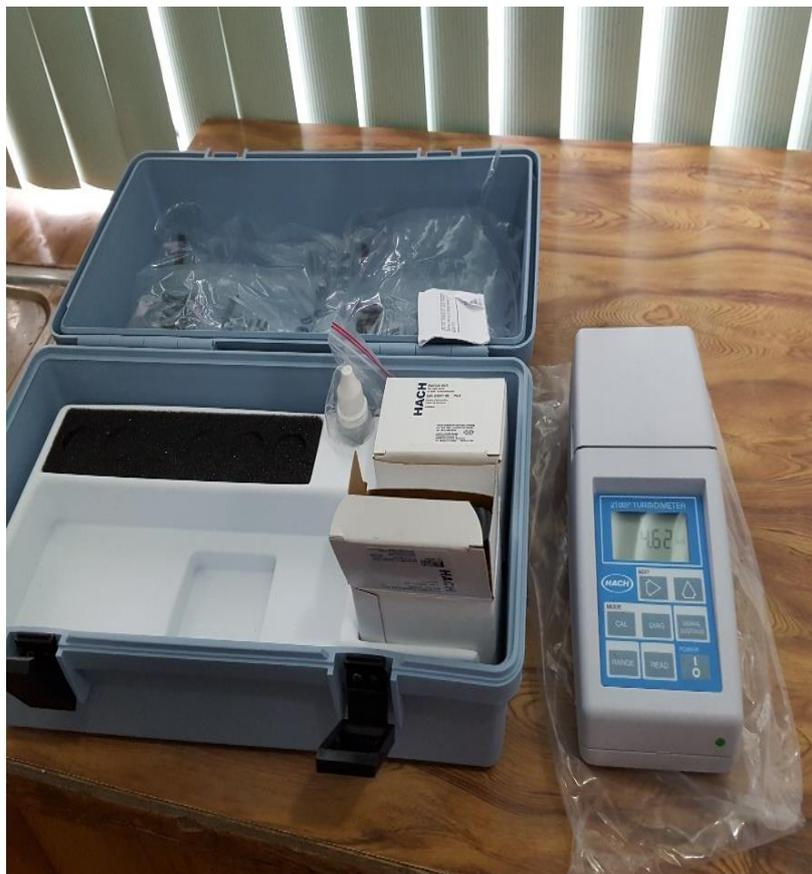
**Fotografía 2-1.** Turbidímetro portátil Hach modelo 2100
