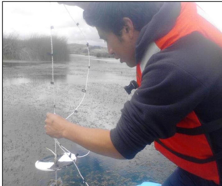
**Fotografía 1-2.** Uso del Disco Secchi desde una embarcación
