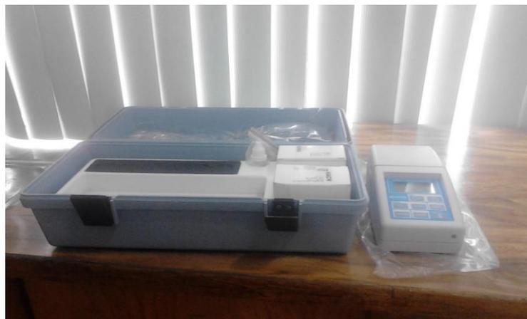
**Fotografía 3-2.** Determinación de la turbidez mediante el uso del turbidímetro
