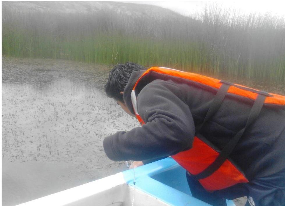
**ANEXO O.** Medición de la altura del disco Secchi junto a las totoras de la laguna Kulta Kucha.
