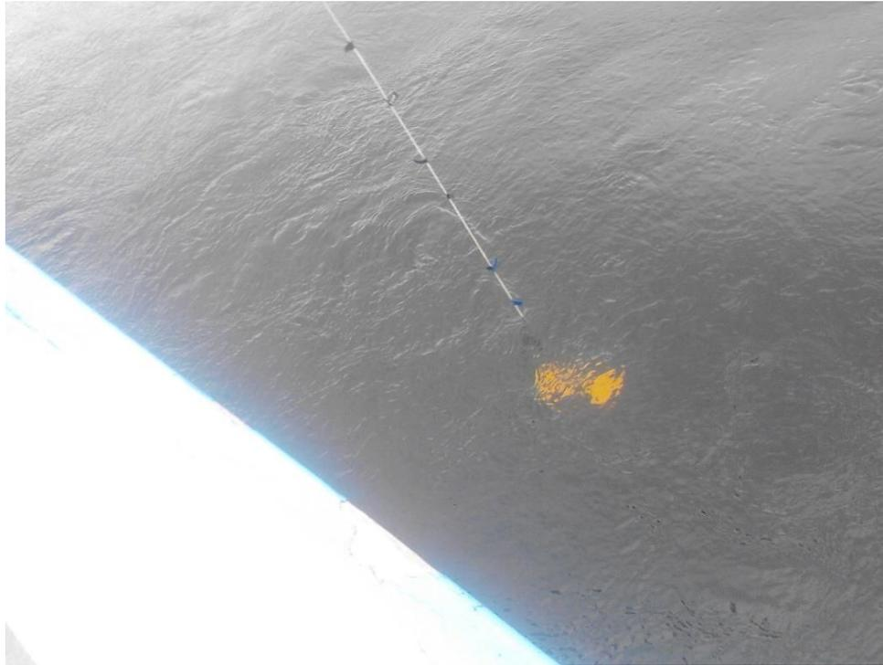
**ANEXO N.** Medición de la altura del disco Secchi en el centro de la laguna Kulta Kucha.
