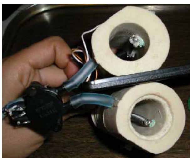
Figura VII.22: colocación de la resistencia neumática en el surco para su fijación
